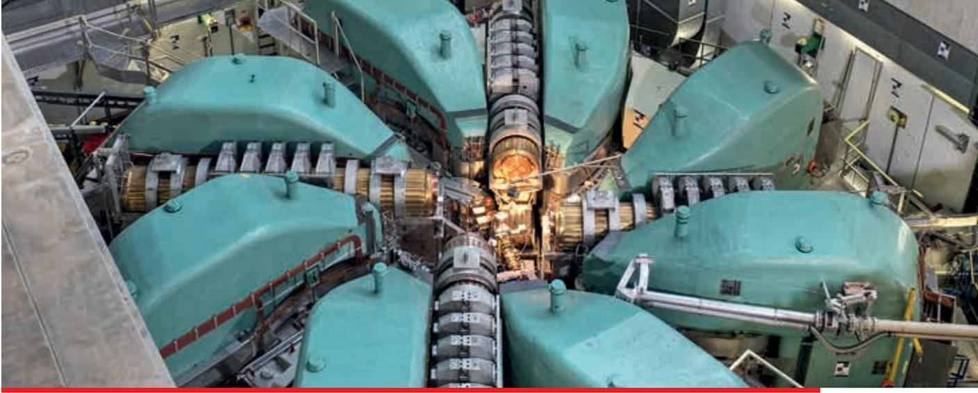
Die Protonenbeschleunigeranlage des Paul Scherrer Instituts erzeugt den leistungsstärksten Protonenstrahl weltweit. Damit können Neutronen aus Blei und Myonen aus Kohlenstoff freigesetzt werden, mit denen man Materialien untersuchen kann.
