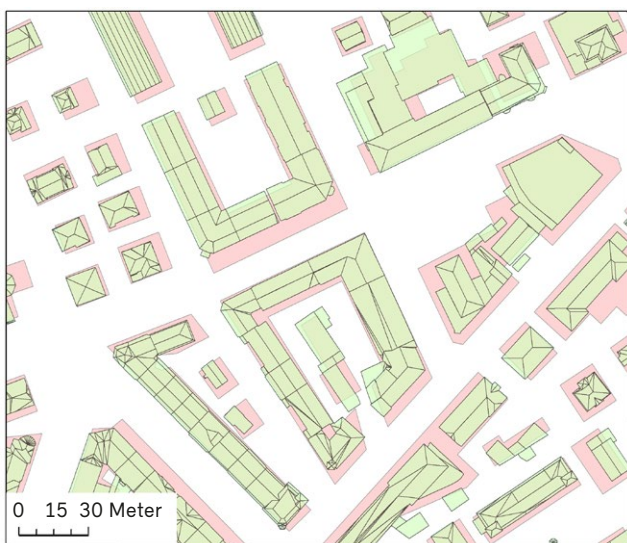
Abbildung 18 Vergleich der Lagegenauigkeit der Gebäudedatensätze VECTOR25 (rot) und swissBUILDINGS 3D (grün)
