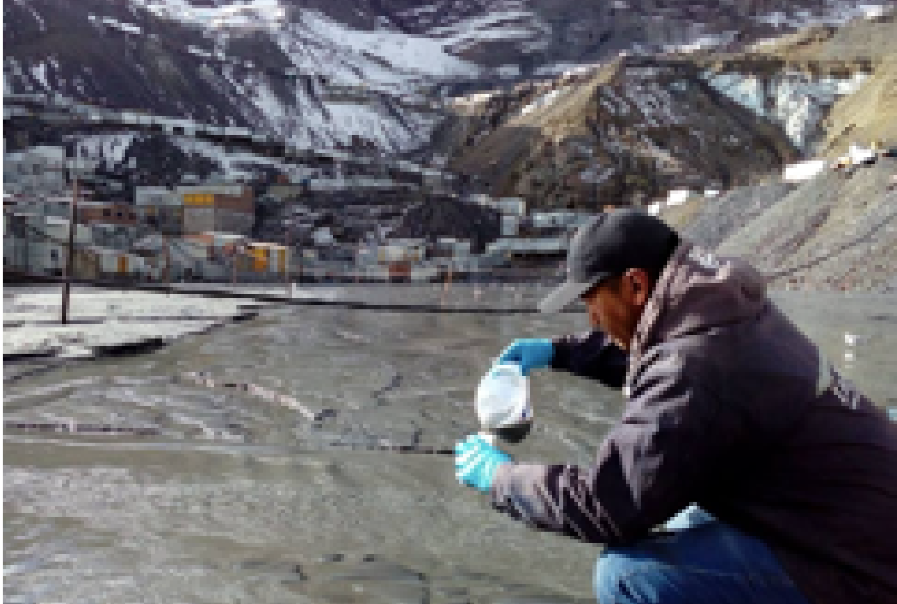
Probenahme bei der Goldmine La Rinconada (Peru) zur Überprüfung der Quecksilberbelastung (Greenpeace 2019) 17 .
