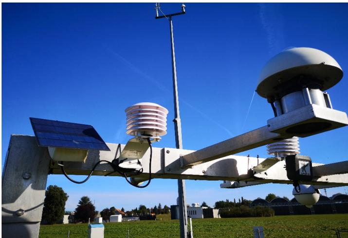
*Bild: Vergleichsmessungen eines Temperaturmessgeräts an der Messstation von MeteoSchweiz in Payerne vor dessen Einsatz in Tadschikistan. Quelle: MeteoSchweiz*
