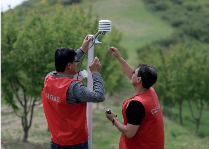
*Mitarbeiter von Caritas Schweiz bei der Installation einer ‚low-cost‘ Wetterstation. Die geringen Kosten und das wartungsarme Design erlauben den Aufbau eines Messnetzes mit hoher Dichte.*
