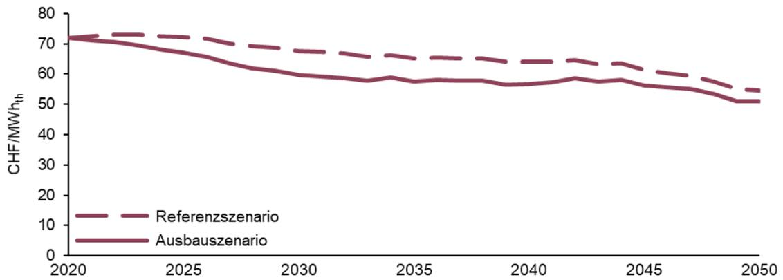
Abbildung A. 11. Berechnete Entwicklung der Heizkosten von Altbauten anhand der Anteile der Heizsysteme am Bestand in Abbildung A. 10 und den Energiepreisen in Tabelle A. 7.
