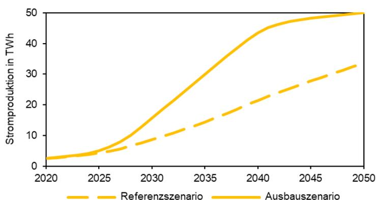
Abbildung A. 1. Ausbaukurven für die Photovoltaik im Ausbauszenario (durchgezogene Linie) und Referenzszenario (gestrichelte Linie) bis 2050.
