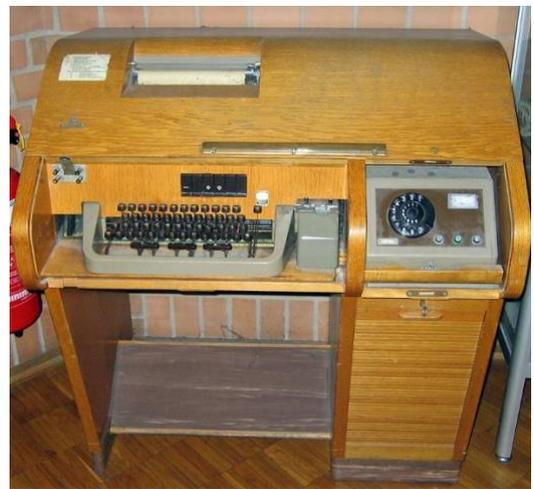
*Siemens T-100, typisches Telex-Endgerät*
