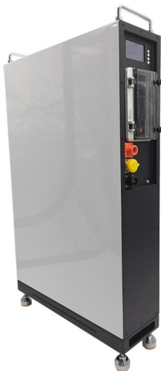
Bild: 10 kWh Batteriespeicher für Zuhause, Boden stehende lithium LiFePO4, Standzeit: 5-10 Jahre, 90.6kg, Kosten rund 10'000 Euro, 50\*17\*82 cm.<sup>56</sup>
